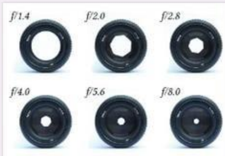
Фиг.1. Диафрагма на обектив с различни апертури
